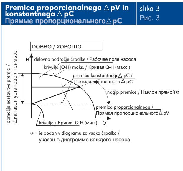
Правильный выбор регулируемого насоса (сравнение характеристик насоса, затребованных проектной документацией, с характеристиками реального насоса) показано на рис. 3, 4 и 5.
