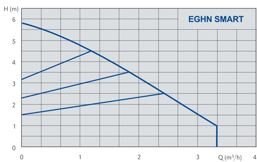
**Elektronsko regulirane obtočne črpalke s prigrajenim frekvenčnim pretvornikom**
